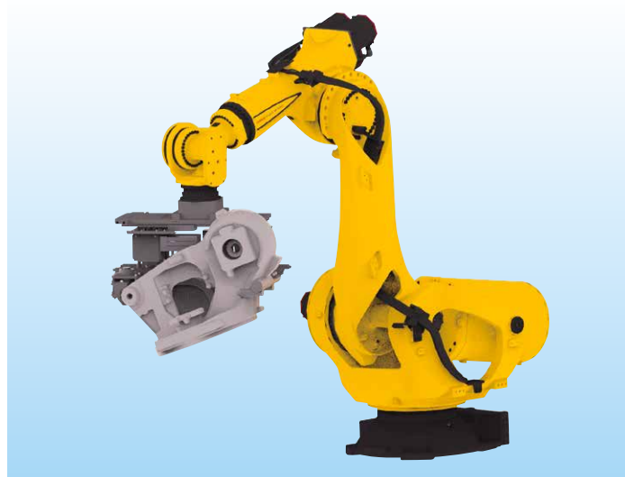
大型鋳物のハンドリング
